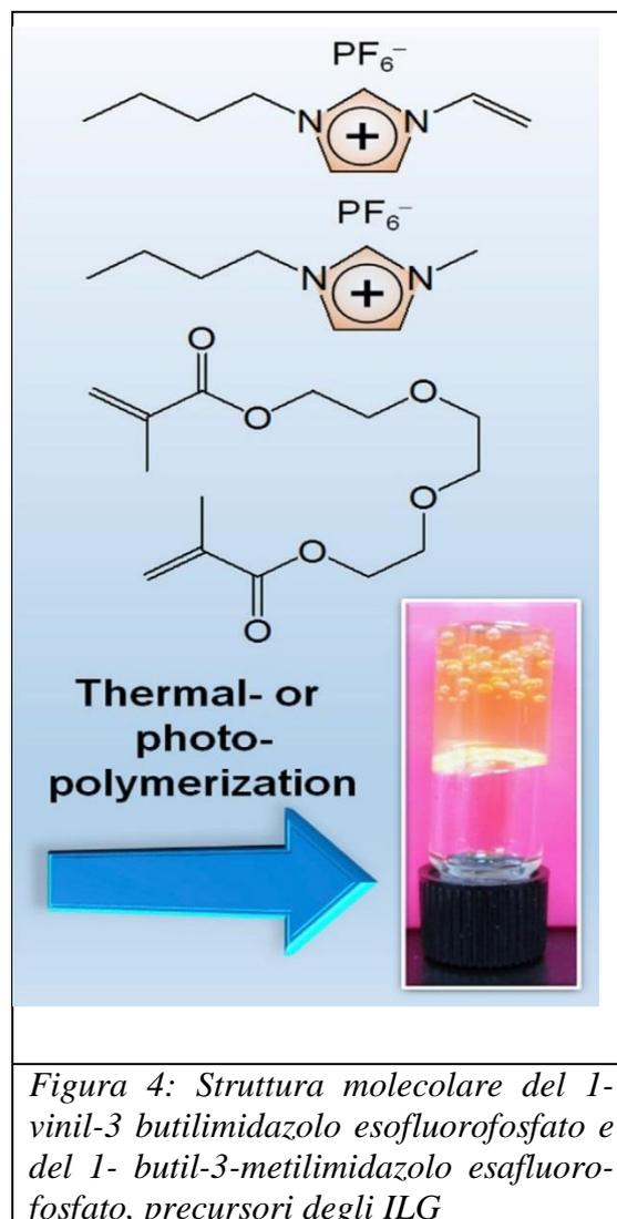
Figura 4: Struttura molecolare del 1-vinil-3 butylimidazolo esofluorofosfato e del 1- butil-3-metilimidazolo esafluorofosfato, precursori degli ILG
